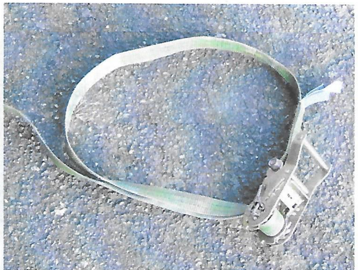
Kopfschlinge aus einem einteiligen Zurrgurt
