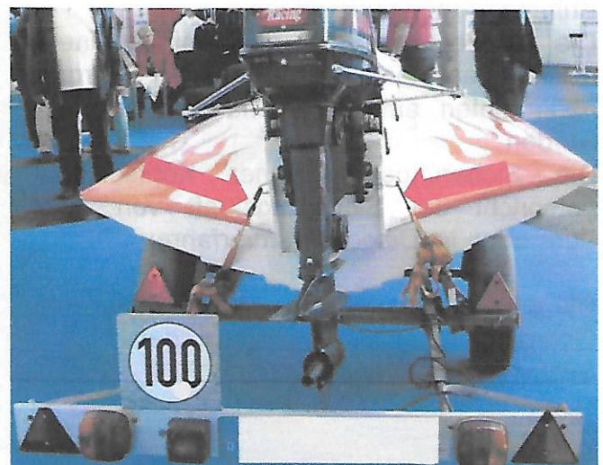
Nach Belastung ausgerissene Klampe, da höchstwahrscheinlich der Unterbau zu schwach ausgelegt war.
