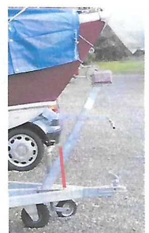
Bugstütze mit einem sehr kurzen Widerlager nach vorn
