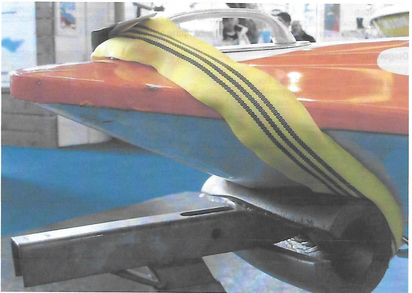
Kopfschlinge mittels Schlaufengurt
