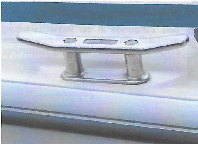
Nicht jeder Zurpunkt/jede Klampe ist für die Ladungs-sicherung geeignet. Festigkeit der Bauweise und der Befestigung sorgfältig prüfen. Augenscheinlich stabiler und geeigneter Zurpunkt/Klampe.
