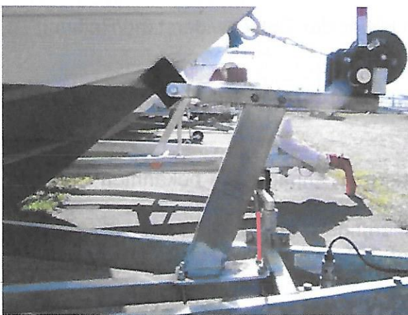
Das Widerlager dieser Bugstütze befindet sich bis zur halben Höhe der Stütze
