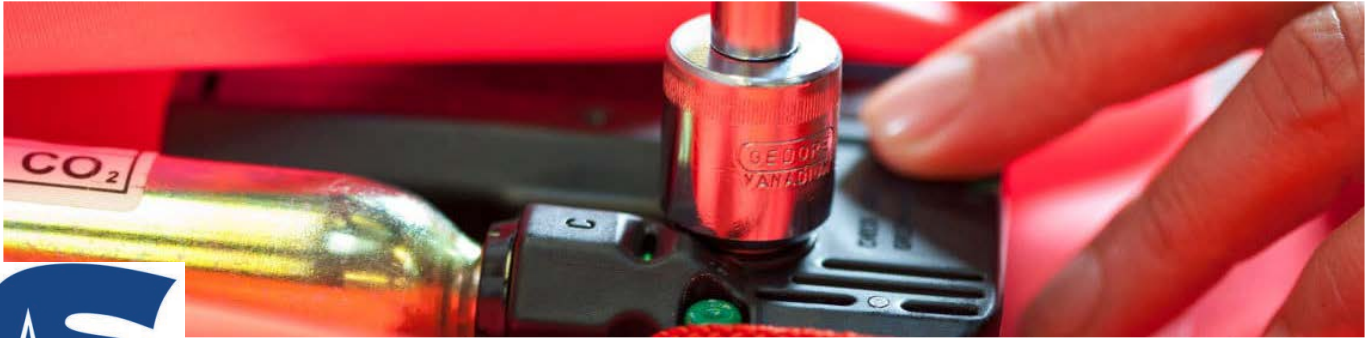
Re-Montage der Auslösevorrichtung: Verschraubungen mittels elektronischer Drehmomentüberwachung
